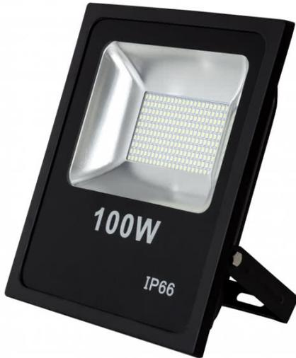
Proyector led serie QUIRON realizado en aluminio color negro. Tiene unas medidas de 30x35x6,5 centímetros y un peso neto de 2525 gramos. Su potencia de luz es de 100 vatios, 7900 lúmenes y 6500K. Tiene un índice de protección IP66 y un ángulo de luz de 120°.
