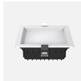
Downlight cuadrado de empotrar de la serie INTEGO en color BLANCO. De diseño moderno y de fácil instalación. Realizado con materiales de muy buena calidad, metal y policarbonato. Tiene TECNOLOGIA LED INTEGRADA con una potencia de 26 vatios, 1490 lúmenes y 6400K de temperatura de luz, blanco frío. Sus medidas son de 7x18x18 centímetros, con una medida de corte de 15,5x15,5 centímetros, quedando un canto en la superficie de tan solo 0,5 centímetros al empotrarse.
