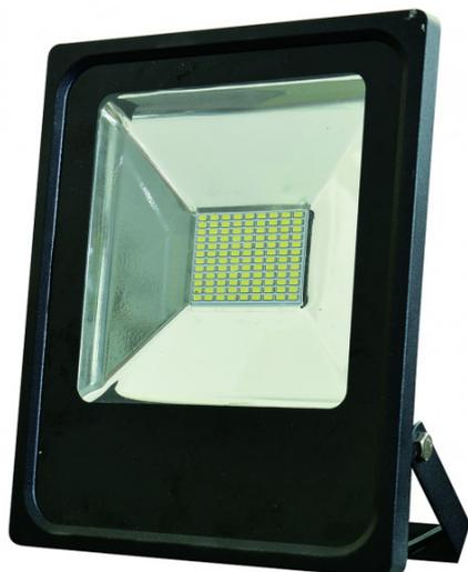
Proyector LED CON SENSOR serie QUIRON realizado en aluminio color negro. Tiene unas medidas de 28,5x27,5x5 centímetros y un peso neto de 1690 gramos. Su potencia de luz es de 50 vatios, 4000 lúmenes y 6500K. Detecta movimiento en un ángulo de 120° y alcanza una distancia de hasta 12 metros. La luz permanecerá encendida una vez activada 35 segundos desde que detecte el último movimiento. Índice de protección IP66.
