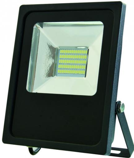
Proyector LED CON SENSOR serie QUIRON realizado en aluminio color negro. Tiene unas medidas de 23x22,5x4,5 centímetros y un peso neto de 1170 gramos. Su potencia de luz es de 30 vatios, 2400 lúmenes y 6500K. Detecta movimiento en un ángulo de 120° y alcanza una distancia de hasta 12 metros. La luz permanecerá encendida una vez activada 35 segundos desde que detecte el último movimiento. Índice de protección IP66.
