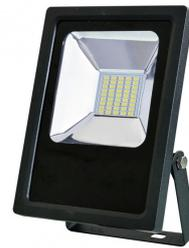
Proyector LED CON SENSOR serie QUIRON realizado en aluminio color negro. Tiene unas medidas de 18x18x4 centímetros y un peso neto de 760 gramos. Su potencia de luz es de 20 vatios, 1600 lúmenes y 6500K. Detecta movimiento en un ángulo de 120° y alcanza una distancia de hasta 12 metros. La luz permanecerá encendida una vez activada 35 segundos desde que detecte el último movimiento. Índice de protección IP66.
