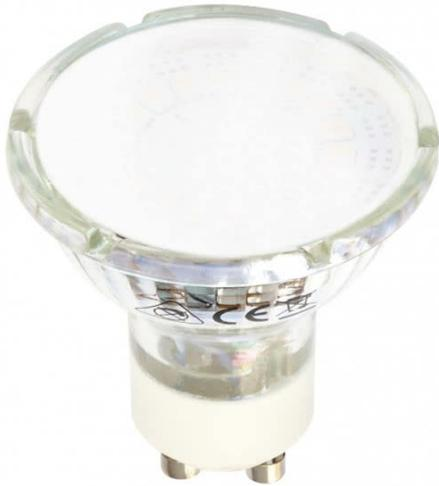
Bombilla LED de cristal con portalámparas GU-10. Sus medidas son de 5,4x5x5 centímetros y un peso neto de 30 gramos. Potencia de 5 vatios, 500 lúmenes y 40.000 horas de vida útil. Tono de luz cálida (2700k). La tecnología LED es muy eficiente, de bajo consumo y larga duración. Eficiencia energética: A+.
