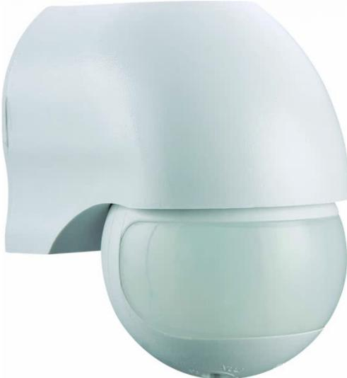
Sensor de movimiento de pared serie MOVE en color blanco. Realizado en policarbonato. Tiene unas medidas de 9x6,5x7,5 centímetros y un peso neto de 160 gramos. Su ángulo de cobertura es de 180º y tiene un campo de detección de hasta 12 metros. Índice de protección 44.
