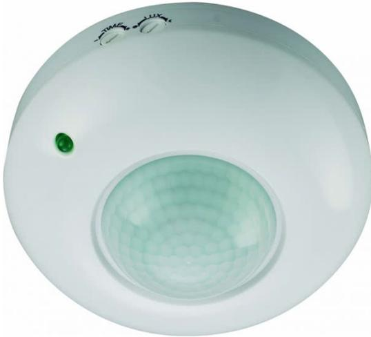
Sensor de movimiento de techo serie MOVE de color BLANCO. Realizado en aluminio y policarbonato. Tiene un campo de detección de hasta 6 metros y sensor con ángulo de cobertura de 360°. Mide 6x11,5x11,5 centímetros y tiene un peso neto de 160 gramos. Con un índice de protección IP20, recomendado para interiores. En esta misma serie puede encontrar varios tipos de sensores para escoger el que mejor se adapte a las necesidades requeridas.
