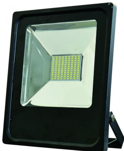
Proyector led serie QUIRON realizado en aluminio color negro. Tiene unas medidas de 23,8x28,8x6,2 centímetros y un peso neto de 1860 gramos. Su potencia de luz es de 50 vatios, 4250 lúmenes y 3000K. Tiene un índice de protección IP66 y un ángulo de luz de 120°.
