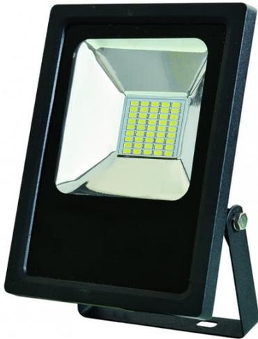
Proyector led serie QUIRON realizado en aluminio color negro. Tiene unas medidas de 14x18x4,5 centímetros y un peso neto de 670 gramos. Su potencia de luz es de 20 vatios, 1700 lúmenes y 3000K. Tiene un índice de protección IP66 y un ángulo de luz de 120°.
