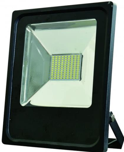
Proyector led serie QUIRON realizado en aluminio color negro. Tiene unas medidas de 23,8x28,8x6,2 centímetros y un peso neto de 1860 gramos. Su potencia de luz es de 50 vatios, 4500 lúmenes y 6500K. Tiene un índice de protección IP66 y un ángulo de luz de 120°.
