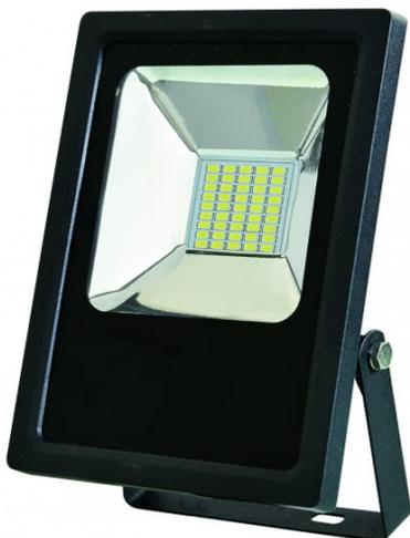
Proyector led serie QUIRON realizado en aluminio color negro. Tiene unas medidas de 14x18x4,5 centímetros y un peso neto de 670 gramos. Su potencia de luz es de 20 vatios, 1800 lúmenes y 6500K. Tiene un índice de protección IP66 y un ángulo de luz de 120°.
