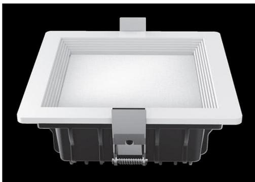
Downlight cuadrado de empotrar de la serie INTEGO en color BLANCO. De diseño moderno y de fácil instalación. Realizado con materiales de muy buena calidad, metal y policarbonato. Tiene TECNOLOGIA LED INTEGRADA con una potencia de 21 vatios, 1130 lúmenes y 4000K de temperatura de luz, blanco natural. Sus medidas son de 6x14x14 centímetros, con una medida de corte de 12x12 centímetros, quedando un canto en la superficie de tan solo 0,5 centímetros al empotrarse.
