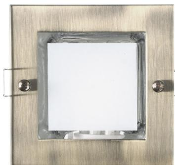
Downlight cuadrado de empotrar de la serie MINI DOWN en color CUERO. Fácil instalación. Realizado con materiales de muy buena calidad, metal y el cristal templado. Posee un porta lámparas E27. Bombilla de bajo consumo 11w INCLUIDA. Sus medidas son de 7,7x12x12 centímetros, con una medida de corte de 10,8x10,8 centímetros y canto que queda en la superficie de 0,5 centímetros.
