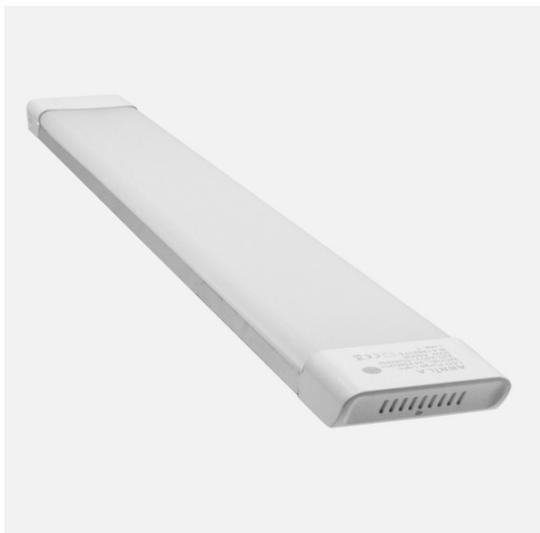
Regleta de la serie HORIZONTE de color BLANCO con TECNOLOGÍA LED INTEGRADO de 60 centímetros de largo. Realizado en aluminio y policarbonato. Tiene una potencia de luz de 48 vatios, 4800 lúmenes y 4000k de temperatura de luz (blanco natural). Tiene unas dimensiones de 2,5x60x10 centímetros. En esta serie encontramos las regletas de 60, 120 y 150 centímetros con sus correspondientes potencias, todas disponibles tanto con luz natural (4000K) como con luz fría (6500K).
