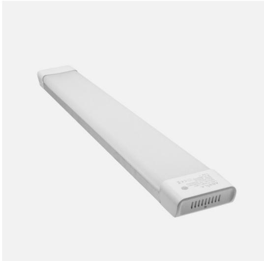
Regleta de la serie OCCIDENTE de color blanco con TECNOLOGÍA LED INTEGRADO de 60 centímetros de largo. Realizado en aluminio y policarbonato. Tiene una potencia de luz de 30 vatios, 3000 lúmenes y 6500k de temperatura de luz (blanco frío). Tiene unas dimensiones de 2,5x60x7,5 centímetros. En esta serie encontramos las regletas de 60, 120 y 150 centímetros con sus correspondientes potencias, todas disponibles tanto con luz natural (4000K) como con luz fría (6500K).
