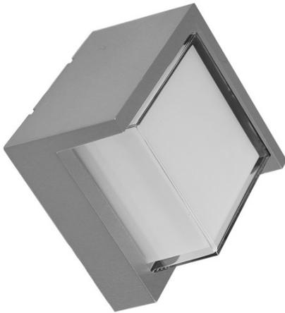
Aplique de exterior de la serie ANOA de color GRIS con forma cuadrada, con diseño original y moderno. Realizado en ABS y policarbonato. Sus dimensiones son 16x16x10,2 centímetros. Con TECNOLOGIA LED INTEGRADA tiene una potencia de 12 watos, 600lm y una temperatura de luz de 3000K, luz cálida. Está preparado para exterior con un índice de protección de IP65. Modelo disponible en Gris y en Negro.
