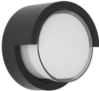
Aplique de exterior de la serie BEJEL de color NEGRO con forma circular, con diseño original y moderno. Realizado en ABS y policarbonato. Sus dimensiones son 17x17x10,2 centímetros. Con TECNOLOGIA LED INTEGRADA tiene una potencia de 12 watos, 600lm y una temperatura de luz de 3000K, luz cálida. Está preparado para exterior con un índice de protección de IP65. Modelo disponible en Gris y en Negro.
