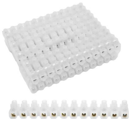
Regleta de ficha de empalme o ficha de conexión de 30 amperios/ 16 mm<sup>2</sup>, envase de 10 regletas de 12 fichas/secciones cada una. Realizadas en cobre y polietileno (PE) semitransparente. Flexible y fácil de cortar, con buena elasticidad, resistente tanto a abajas como a altas temperaturas.
