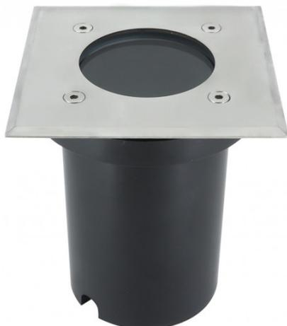
Empotrable exterior cuadrado de la serie ENCASTRAR en color NIQUEL. Realizado en metal. Posee un portalámparas GU10, bombilla o incluida. Tiene un índice de protección IP65, diseñado para empotrar en el exterior. Posee unas dimensiones de 13x11x11 centímetros con corte para su instalación de 10,5 centímetros de diámetros. en esta serie podemos encontrar este empotrable tanto redondo como cuadrado.
