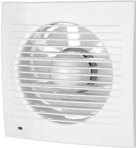
Extractor de baño de la serie SOLEAS de 15W de potencia en color BLANCO. Este modelo se recomienda para tubos de 15 centímetros. Realizado en un material ligero ABS. Ofrece un índice muy bajo de ruido, 36 decibelios y un flujo de aire de 220 metros cúbicos/hora. Tiene una medida de 21x21x8 centímetros.
