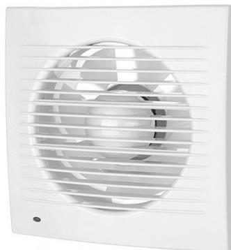
Extractor de baño de la serie SOLEAS de 12W de potencia en color BLANCO. Este modelo se recomienda para tubos de 10 centímetros. Realizado en un material ligero ABS. Ofrece un índice muy bajo de ruido, 32 decibelios y un flujo de aire de 120 metros cúbicos/hora. Tiene una medida de 16x16x7 centímetros.
