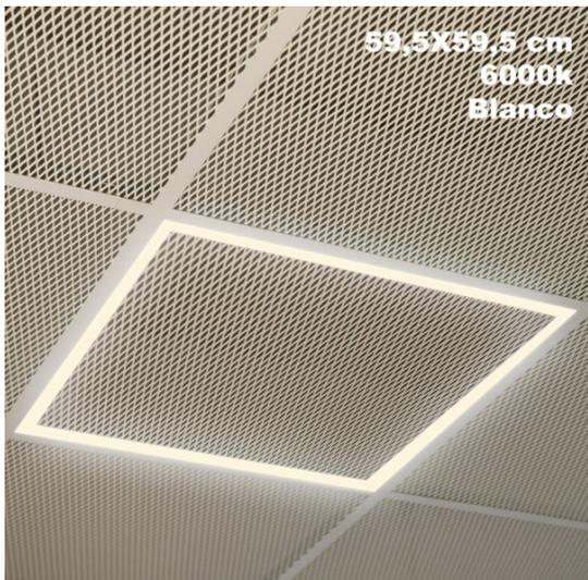
Marco de Panel de empotrar Led LORENZO de color BLANCO. Realizado en aluminio y policarbonato. Tecnología LED INTEGRADO con una potencia de 48 vatios, 4400 lúmenes y una temperatura de luz de 6000°K, blanco frío. Tiene una medida de 1,5x59,5x59,5 centímetros, con una medida de corte cuadrado de 57,5x57,5 centímetros. Tiene un CRI>80. Se vende en PACK de 2 unidades. También disponible en esta serie el perfil de 4000°K, blanco natural.
