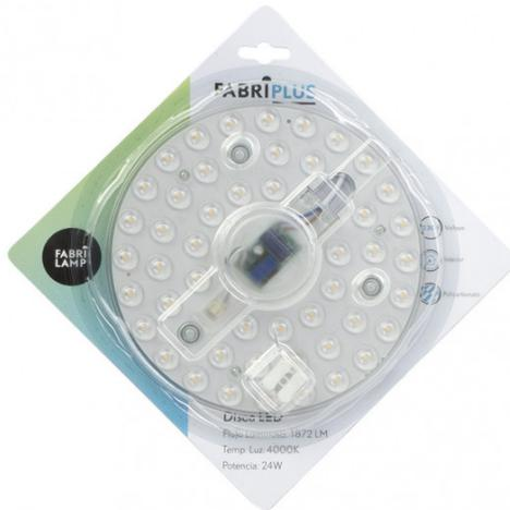
Disco de LED de 24 vatios de la serie PLACA con una temperatura de luz de 4000°K, blanco natural y 1872 lúmenes. Fuente de luz con TECNOLOGÍA LED INTEGRADA para sustituir o reparar downlights, plafones focos, etc. No regulable. Tiene unas dimensiones de 17x17x2,5 centímetros. Disponible en esta serie los discos led tanto de 24 como de 12 vatios, con luz cálida, blanco natural o blanco frío, en sus respectivos tamaños, y también magnéticos.
