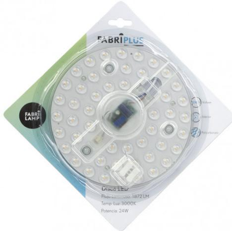
Disco de LED de 24 vatios de la serie PLACA con una temperatura de luz de 3000°K, luz cálida y 1872 lúmenes. Fuente de luz con TECNOLOGÍA LED INTEGRADA para sustituir o reparar downlights, plafones focos, etc. No regulable. Tiene unas dimensiones de 17x17,5 centímetros. Disponible en esta serie los discos led tanto de 24 como de 12 vatios, con luz cálida, blanco natural o blanco frío, en sus respectivos tamaños, y también magnéticos.
