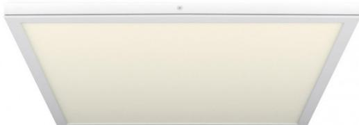
Panel de superficie TIVOLI realizado en metal de color BLANCO y policarbonato. Posee Tecnología Led con una potencia de 36 vatios, 3060 lúmenes y 4000K, blanco natural. Tiene una medida de 2,5x40x40 centímetros. En esta serie encontramos paneles tanto de 40x40 como de 30x60,30x90 y 30x120 centímetros, todos en 4000K (blanco natural) y en 6500K (blanco frío). Disponibles también en color níquel.
