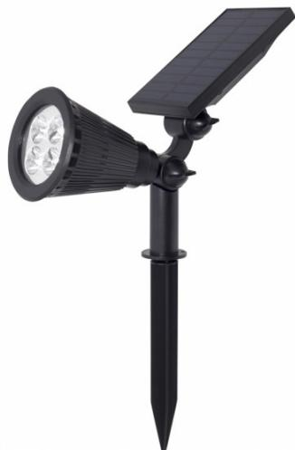
Pincho solar con tecnología Led de color negro. El color de la luz que emite tiene una temperatura de 3000K, blanco cálido, con una potencia de 2 watos y 300 lúmenes. Se compone de un panel solar con sensor crepuscular. También posee un interruptor de apagado. Su instalación es mediante un vástago que se inserta en la tierra. Sus dimensiones son 42x9,2x27 cm y el índice de protección es IP65.
