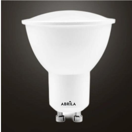
Bombilla LED DICROICA GU10 de la serie ABRILA, realizada en polímero blanco y aluminio. Con portalámparas GU10, tiene una potencia de luz de 11 watos, 990 lúmenes y 3000K de temperatura de luz, luz cálida. Sus medidas son de 5,5X5X5 centímetros y tiene un peso neto de 45 gramos.
