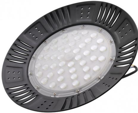
Campana led de la serie GRANITO realizada en aluminio y policarbonato. De color NEGRO. Tiene unas medidas de 11X40X40 centímetros y un peso neto de 2185 gramos. Su potencia de luz es de 200 vatios y 22000 lúmenes, con una temperatura de luz de 6500K (blanco frío). Tiene un ángulo de luz de 120°. Disponible en esta serie de 100, 150 y 200 vatios con sus tamaños correspondientes.
