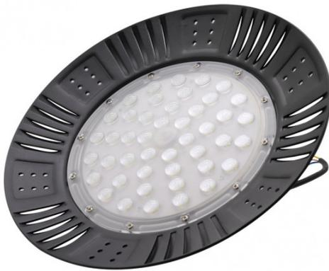
Campana led de la serie GRANITO realizada en aluminio y policarbonato. De color NEGRO. Tiene unas medidas de 11X35X35 centímetros y un peso neto de 1775 gramos. Su potencia de luz es de 150 vatios y 16500 lúmenes, con una temperatura de luz de 6500K (blanco frío). Tiene un ángulo de luz de 120°. Disponible en esta serie de 100, 150 y 200 vatios con sus tamaños correspondientes.
