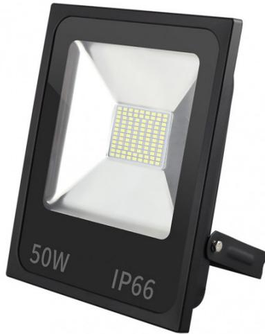
Proyector led serie DACITA realizado en aluminio y cristal. De color NEGRO. Tiene unas medidas de 28,5x24x5,5 centímetros y un peso neto de 1535 gramos. Su potencia de luz es de 50 vatios y 4500 lúmenes. Con una temperatura de color de 6500K. Tiene un índice de protección IP66 y un ángulo de luz de 120°.
