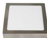
Downlight cuadrado de superficie de la serie TOBA realizado en aluminio color NIQUEL y policarbonato, con unas medidas de 3,5x22,5x22,5 centímetros y un peso neto de 510 gramos. Posee LED INTEGRADO con una potencia de 18 vatios con 1530 lúmenes y una temperatura de 4000K (luz natural). En esta serie podemos encontrarlos de 24 y 12 vatios, también con una temperatura de 6500k (luz super blanco), y todos los modelos y tamaños los hay disponibles en color blanco.
