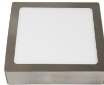
Downlight cuadrado de superficie de la serie TOBA realizado en aluminio color NIQUEL y policarbonato, con unas medidas de 3,5x30x30 centímetros y un peso neto de 815 gramos. Posee LED INTEGRADO con una potencia de 24 vatios con 2040 lúmenes y una temperatura de 6500K (luz super blanco). En esta serie podemos encontrarlos de 18 y 12 vatios, también con una temperatura de 4000k (luz natural), y todos los modelos y tamaños los hay disponibles en color blanco.
