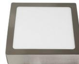
Downlight cuadrado de superficie de la serie TOBA realizado en aluminio color NIQUEL y policarbonato, con unas medidas de 3,5x22,5x22,5 centímetros y un peso neto de 510 gramos. Posee LED INTEGRADO con una potencia de 18 vatios con 1530 lúmenes y una temperatura de 6500K (luz super blanco). En esta serie podemos encontrarlos de 24 y 12 vatios, también con una temperatura de 4000k (luz natural), y todos los modelos y tamaños los hay disponibles en color blanco.
