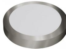
Downlight redondo de superficie de la serie DIABASA realizado en aluminio color NIQUEL y policarbonato, con unas medidas de 3,5x30x30 centímetros y un peso neto de 665 gramos. Posee LED INTEGRADO con una potencia de 24 watos con 2040 lúmenes y una temperatura de 4000K (luz natural). En esta serie podemos encontrarlos de 18 y 12 watos, también con una temperatura de 6500k (luz super blanca), y todos los modelos y tamaños los hay disponibles en color blanco.
