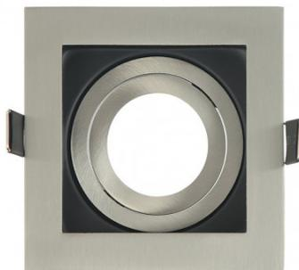
Empotrable orientable serie BATU con forma cuadrada, de color NIQUEL/NEGRO. Realizado en aluminio, aportando durabilidad al foco al ser material de calidad. Su dimensión es de 3,5x10x10 centímetros. Corte REDONDO para su instalación de 9 centímetros de diámetro. Posee un portalámparas GU10. Bombilla no incluida. De diseño moderno y actual, combinando con negro, resultando un foco muy elegante. En esta misma serie también podemos encontrar el foco de color cuero/negro y blanco/negro.
