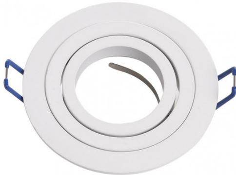
Empotrable orientable serie CENOTE con forma redonda, de color BLANCO. Realizado en aluminio. Su dimensión es 2x9,2x9,2 centímetros. Corte para su instalación de 8 centímetros. Posee un portalámparas GU10. Bombilla no incluida. De diseño moderno, encontrándose, en esta serie, una gran variedad de combinaciones de colores como en Champagne/Cromo, Aluminio/Cromo, Wengué/Cromo, Blanco/Cromo, Cuero y Blanco. También disponibles en forma cuadrada, adaptándose a lo que más combine con su decoración.
