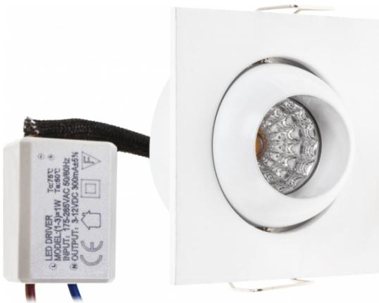
Empotrable orientable cuadrado serie CENTAVO de color BLANCO. Realizado en aluminio con TECNOLOGIA LED INTEGRADO. Tiene una potencia de 1 watio con 65 lúmenes y el color de luz tiene una temperatura de 4000°k, blanco natural. Tiene un índice de protección IP65, con lo que es ideal tanto para exterior como para interior. Sus medidas son de 2,5x5x5 centímetros y tiene 4 centímetros de diámetro de corte para su instalación encastrada. Modelo disponible tanto redondo como cuadrado.
