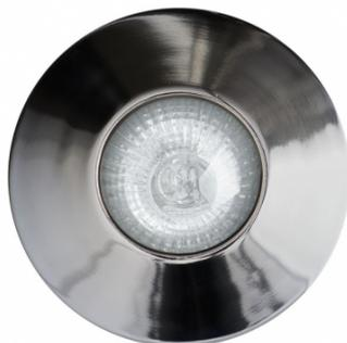
Empotrable TRENZA de color CROMO, realizado en aluminio. Posee un portalámparas GU10, bombilla no incluida. Tiene unas dimensiones de 2,5x9x9 centímetros y un peso neto de 80 gramos. Tiene un corte de 7 centímetros de diámetro para su instalación. En esta serie podemos encontrar los focos en color cromo y en blanco.
