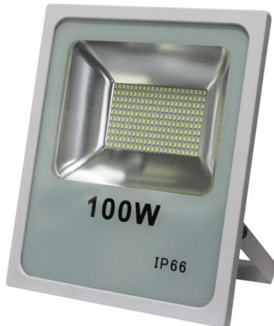
Proyector led serie QUIRON realizado en aluminio color blanco. Tiene unas medidas de 30x35x6,5 centímetros y un peso neto de 2565 gramos. Su potencia de luz es de 100 vatios, 7900 lúmenes y 4000°K. Tiene un índice de protección IP66 y un ángulo de luz de 120º.
