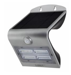
Aplique solar **Serie Solaris** en color plata. Realizado en policarbonato, posee una potencia de 3,2 W, 400 Lm, 4000°k en la parte trasera y 6000°k en la delantera. Su funcionalidad permite que el aplique se encienda tanto cuando baja la luminosidad como cuando detecta movimiento. Incluye una bateria de iones de litio reemplazable. El índice de protección es IP65.
