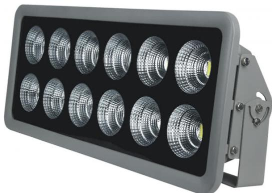
Proyector LED serie SUKRA realizado en aluminio gris oscuro y cristal. Tiene unas medidas de 32,5x80,5x20 centímetros y un peso neto de 15530 gramos. Su potencia de luz es de 600 vatios, 60.000 lúmenes y 6500K. La apertura de luz es de 75° y el índice de protección es IP66.
