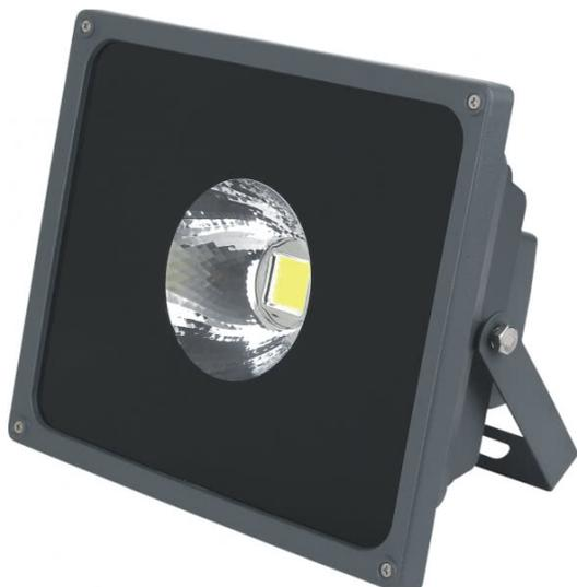
Proyector LED serie SUKRA realizado en aluminio gris oscuro y cristal. Tiene unas medidas de 23,5x28,5x14 centímetros y un peso neto de 2120 gramos. Su potencia de luz es de 50 vatios, 5000 lúmenes y 6500K. La apertura de luz es de 75° y el índice de protección es IP66.
