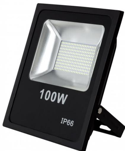
Proyector led serie QUIRON realizado en aluminio color negro. Tiene unas medidas de 30x35x6,5 centímetros y un peso neto de 2525 gramos. Su potencia de luz es de 100 vatios, 7500 lúmenes y 3000K. Tiene un índice de protección IP66 y un ángulo de luz de 120º.
