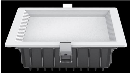
Downlight cuadrado de empotrar de la serie INTEGO en color BLANCO. De diseño moderno y de fácil instalación. Realizado con materiales de muy buena calidad, metal y policarbonato. Tiene TECNOLOGIA LED INTEGRADA con una potencia de 32 vatios, 1880 lúmenes y 6400K de temperatura de luz, blanco frío. Sus medidas son de 7x22x22 centímetros, con una medida de corte de 19x19 centímetros, quedando un canto en la superficie de tan solo 0,5 centímetros al empotrarse
