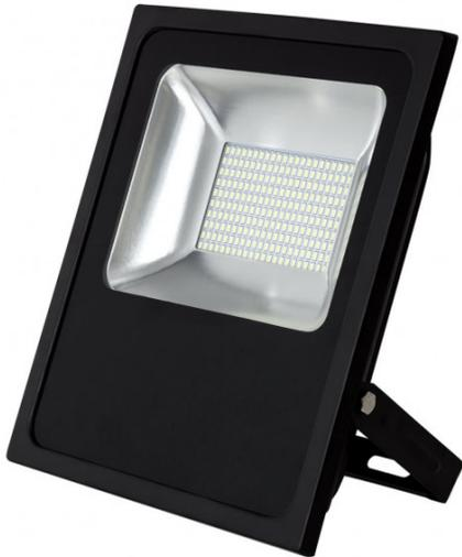
Proyector LED CON SENSOR serie QUIRON realizado en aluminio color negro. Tiene unas medidas de 33,5x29x6 centímetros y un peso neto de 2580 gramos. Su potencia de luz es de 100 watos, 8000 lúmenes y 6500K. Detecta movimiento en un ángulo de 120º y alcanza una distancia de hasta 12 metros. La luz permanecerá encendida una vez activada 35 segundos desde que detecte el último movimiento. Índice de protección IP66.
