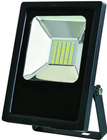
Proyector led serie QUIRON realizado en aluminio color negro. Tiene unas medidas de 14x18x4,5 centímetros y un peso neto de 670 gramos. Su potencia de luz es de 20 vatios, 1800 lúmenes y 6500K. Tiene un índice de protección IP66 y un ángulo de luz de 120º.
