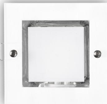
Downlight cuadrado de empotrar de la serie MINI DOWN en color BLANCO. Fácil instalación. Realizado con materiales de muy buena calidad, metal y el cristal templado. Posee un porta lámparas E27. Bombilla de bajo consumo 11w INCLUIDA. Sus medidas son de 7,7x12x12 centímetros, con una medida de corte de 10,8x10,8 centímetros y canto que queda en la superficie de 0,5 centímetros.
