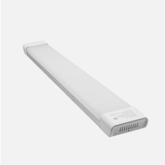
Regleta de la serie OCCIDENTE de color blanco con TECNOLOGÍA LED INTEGRADO de 150 centímetros de largo. Realizado en aluminio y policarbonato. Tiene una potencia de luz de 72 vatios, 7200 lúmenes y 6500K de temperatura de luz (blanco frío). Tiene unas dimensiones de 2,5x150x7,5 centímetros. En esta serie encontramos las regletas de 60, 120 y 150 centímetros con sus correspondientes potencias, todas disponibles tanto con luz natural (4000K) como con luz fría (6500K).
