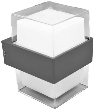
Aplique de exterior de la serie TUCAN de color GRIS con forma cúbica y estilo moderno. Realizado en ABS y policarbonato. Sus dimensiones son 13,3x9,5x10,5 centímetros. Contiene TECNOLOGIA LED INTEGRADA con 8 vatios de potencia, 500 lúmenes y una temperatura de luz de 3000K, luz cálida. Su luz tiene tanto salida superior como inferior dando luz directa e indirecta al mismo tiempo. Está preparado para exterior con un índice de protección de IP44. Modelo disponible en Gris y en Negro.
